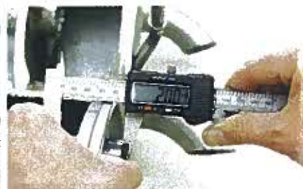
Svar v čele výfuku je technologickou nutností včetně odpaření ochranné hliníkové vrstvy. Naději na delší život přináší tlustší plech, který jsme naměřili u MTS a Škoda Economy.
