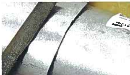
Ze všech výfuků jsme zkoumo obrousili svrchní vrstvu materiálu a tři hodiny máčeli vodou. U pohliníkových se pokaždé vyskytla koroze, pouze u nerezového originálu ne.
