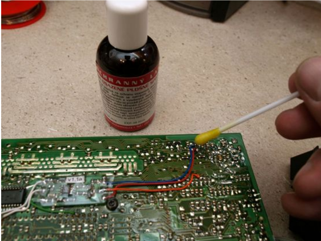
Obr. 22 - Zalakování všech pájených bodů.
