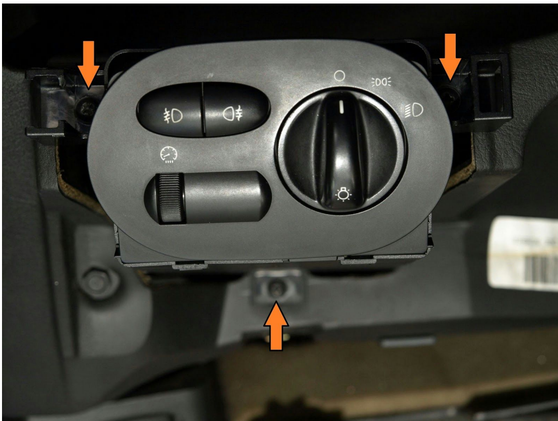
Obr. 4 - Tři vruty upevňující jednotku světel.
