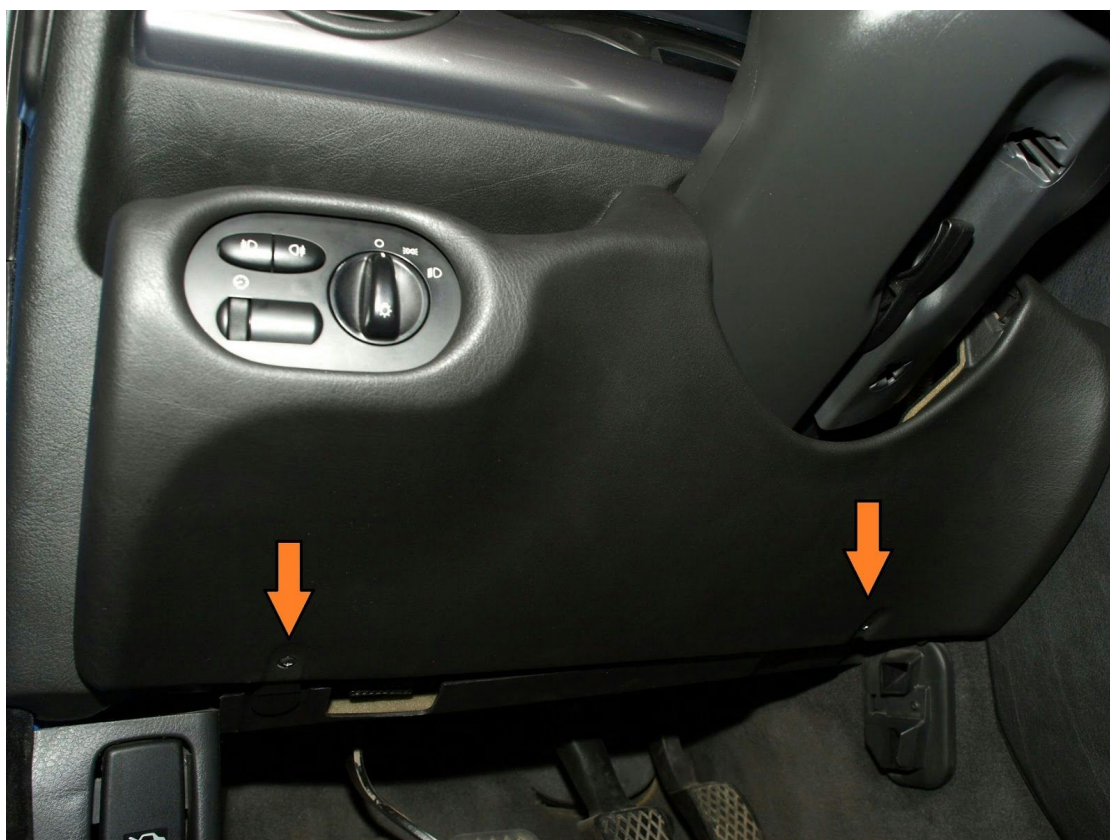
Obr. 1 - Dva vruty v dolní části spodního krytu.
