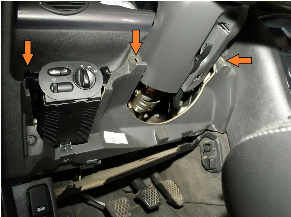
Obr. 2 - Otvory pro klipy dolního krytu.
