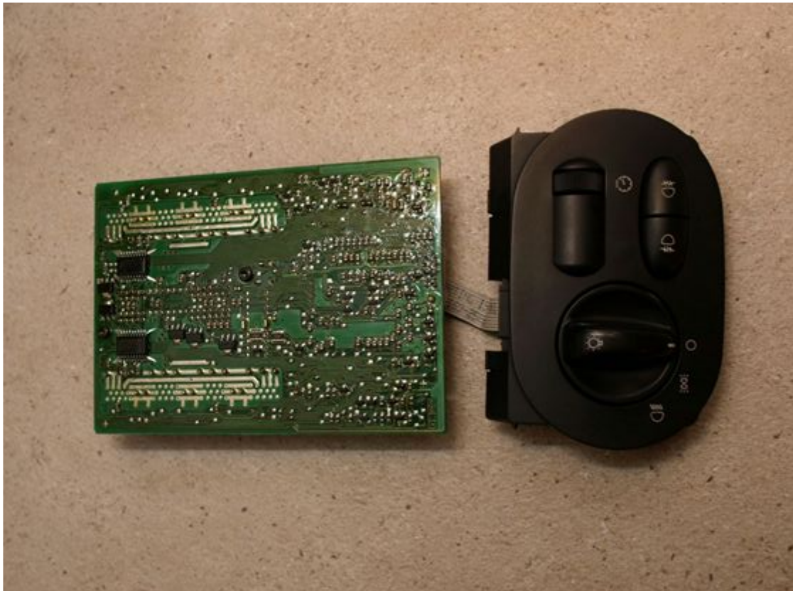
Obr. 9 - Deska jednotky zdola s připojeným předním panelem.
