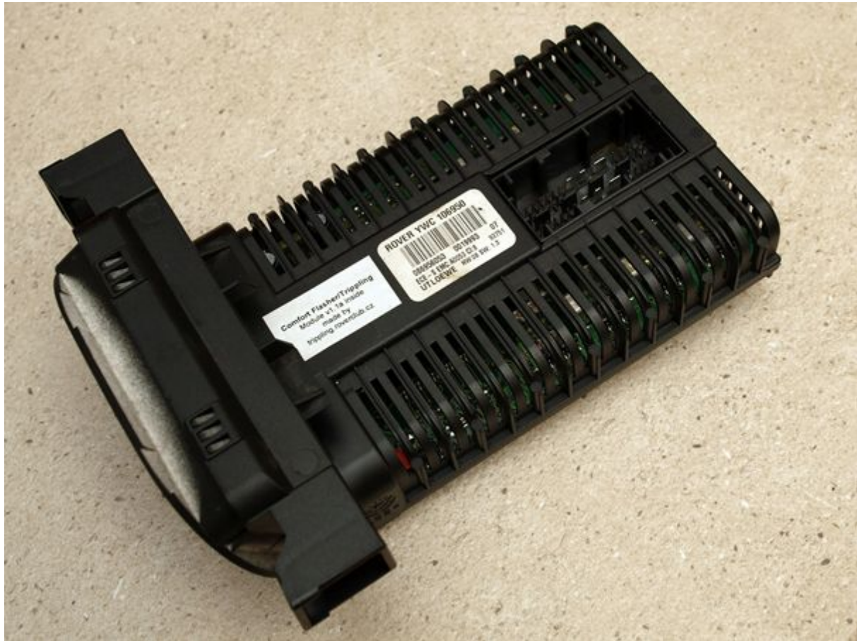
Obr. 24 - Krabička jednotky světél s instalovaným modulem.
