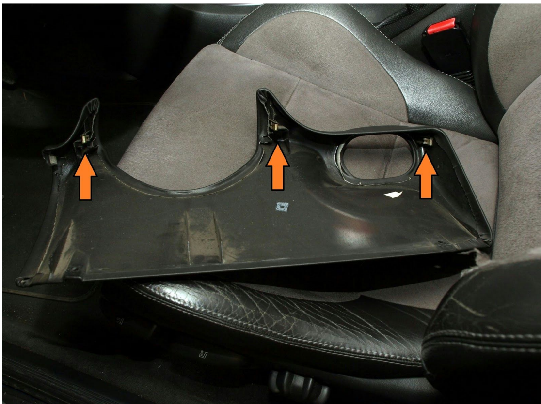
Obr. 3 - Klipy na spodním krytu.
